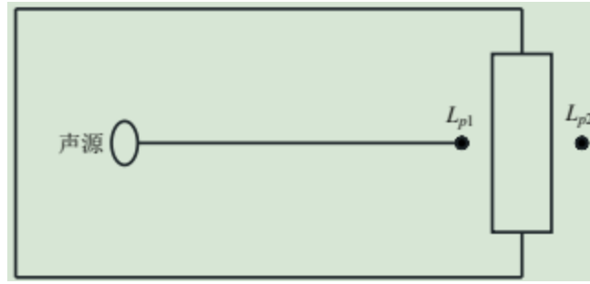
图 4.4 室内声源等效为室外声源图例
