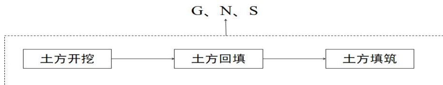
图 2-14 土石方施工工艺流程
