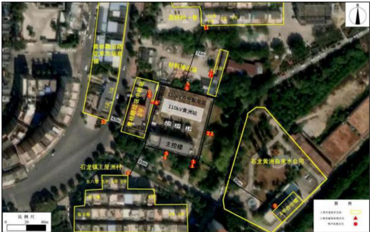
图I-8-1 东莞110千伏黄洲变电站监测布点图
