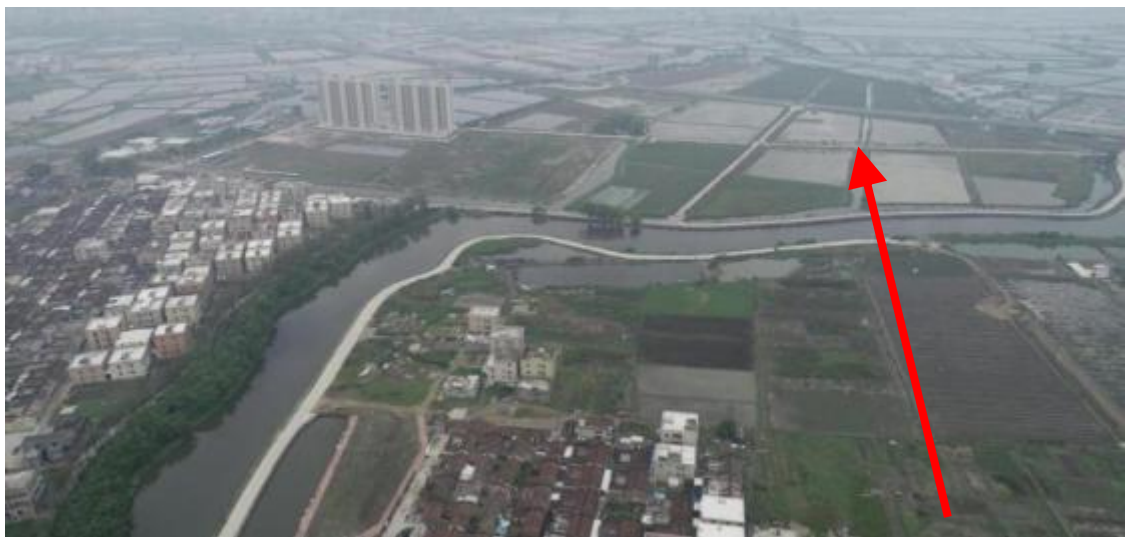
图 2-6 线路方案跨越沟渠示意图
