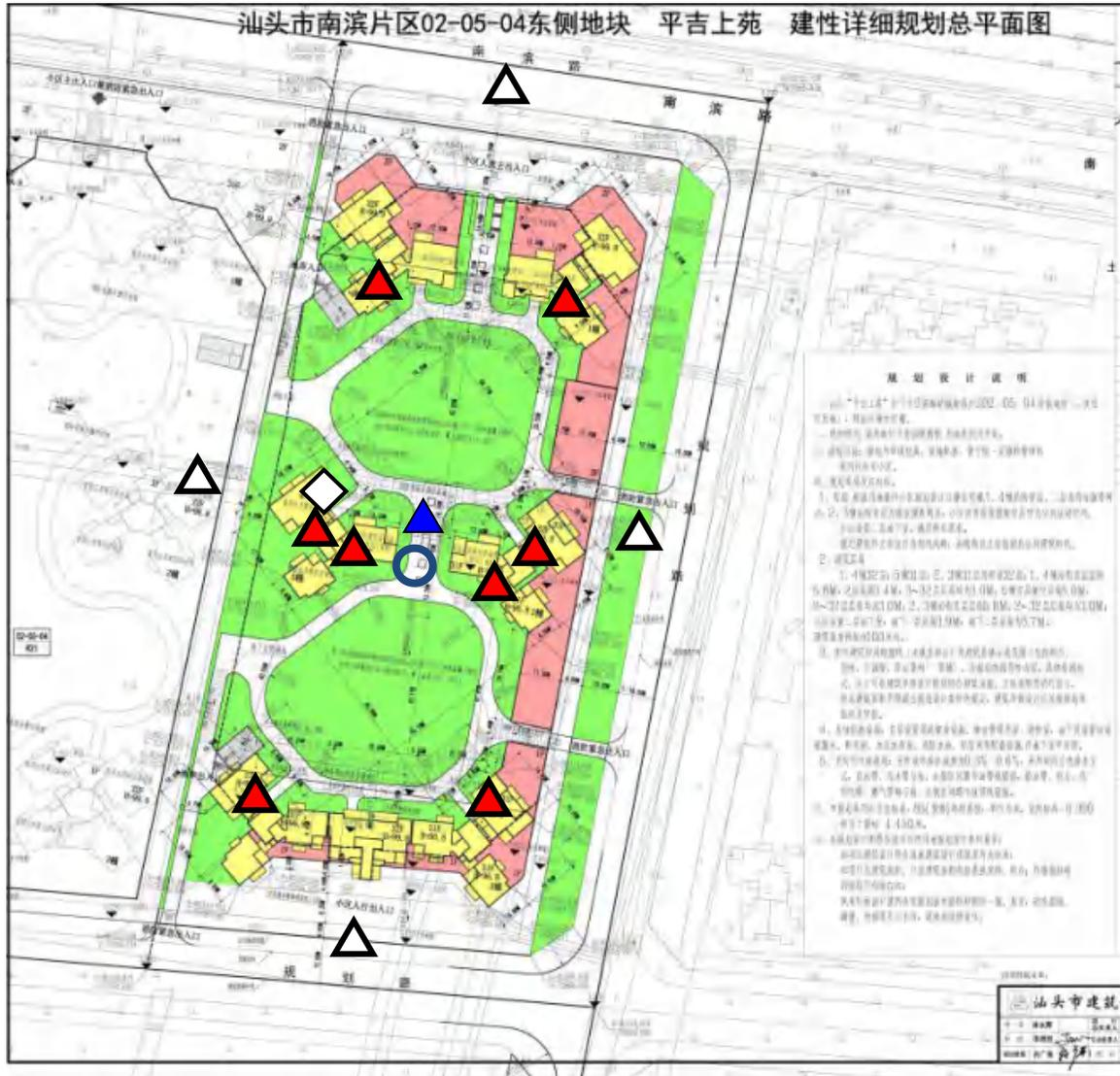
▲边界噪声    ▲结构噪声监测    ▲声环境监测    ○环境空气监测    ◆柴油发电机尾气排放口
